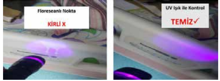
Resim 1. Floresanlı lamba ile temizlik kontrolü
